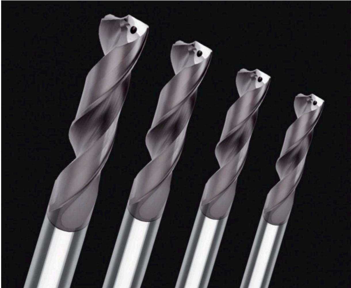
Dank des besonderen Hub-Stirnanschliffs sowie der 6-Flächen-Ausspitzung ist der innengekühlte „SpeedMax“ selbstzentrierend und erzeugt die für die ambitionierten Schnittdaten erforderliche optimale Spanform.
